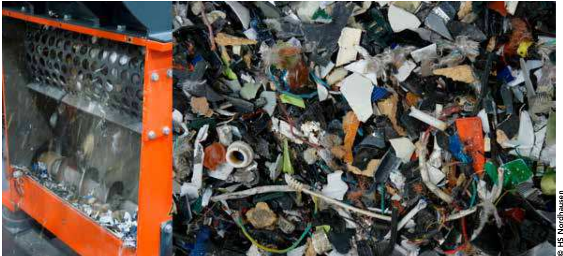
5 Shredder with 30 mm screen liner (left) and shredded WEEE (right) Zerkleinerungsaggregat mit 30 mm Siebeinsatz (links) und zerkleinerte EAG (rechts)
