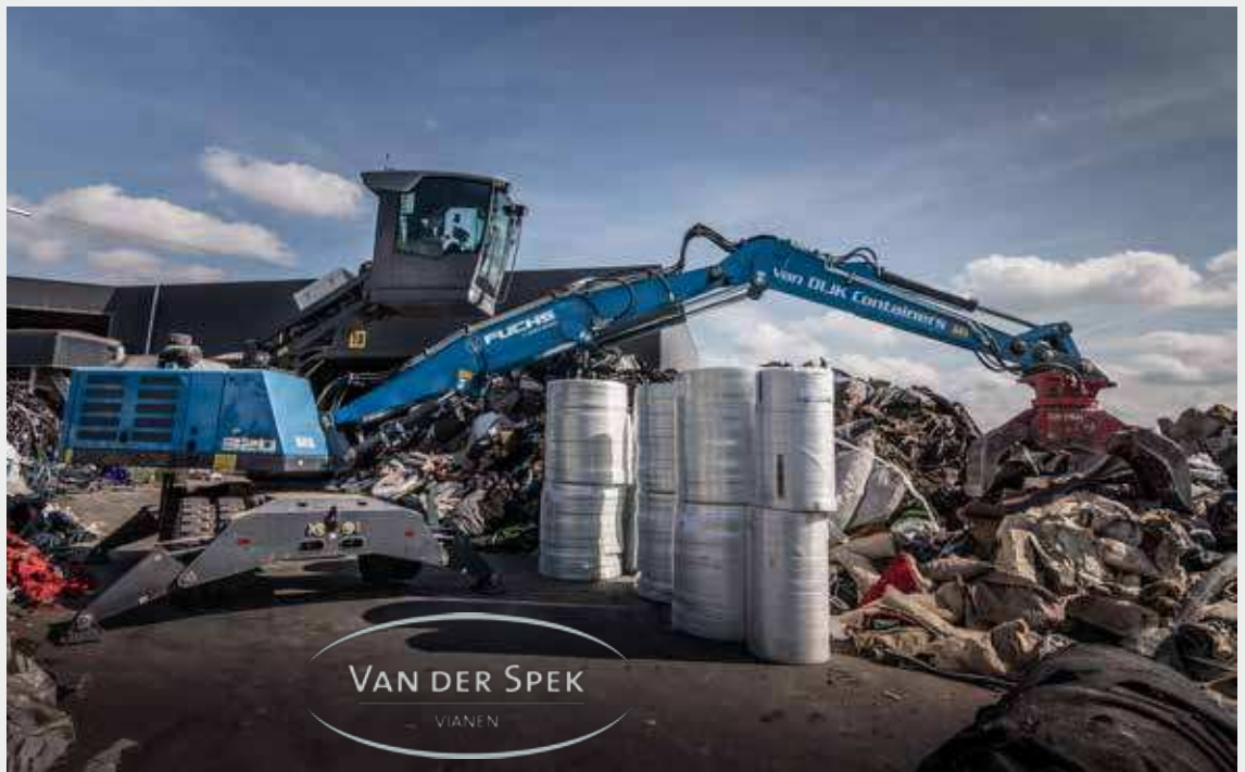
Погрузчик FUCHS MHL320 на сортировке отходов
