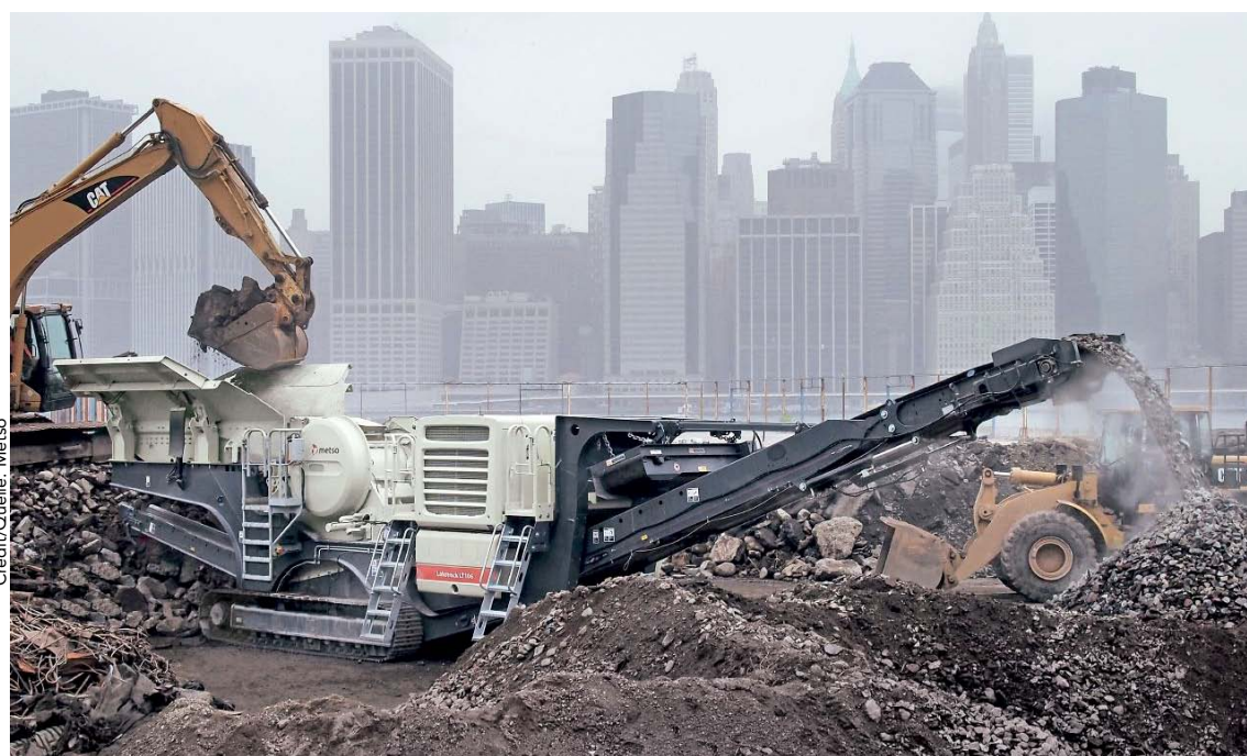
▲ 15 Mobile building rubble processing Mobile Bauschutttauf- bereitung
