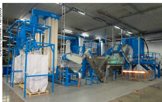
◀ Line for the treatment of post-consumer plastics waste Waschanlage zum Aufbereiten von Post-Consumer-Kunststoffabfällen
