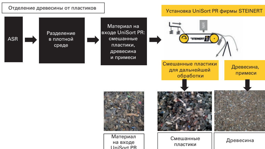
◀ Процесс разделения пластика и дерева
