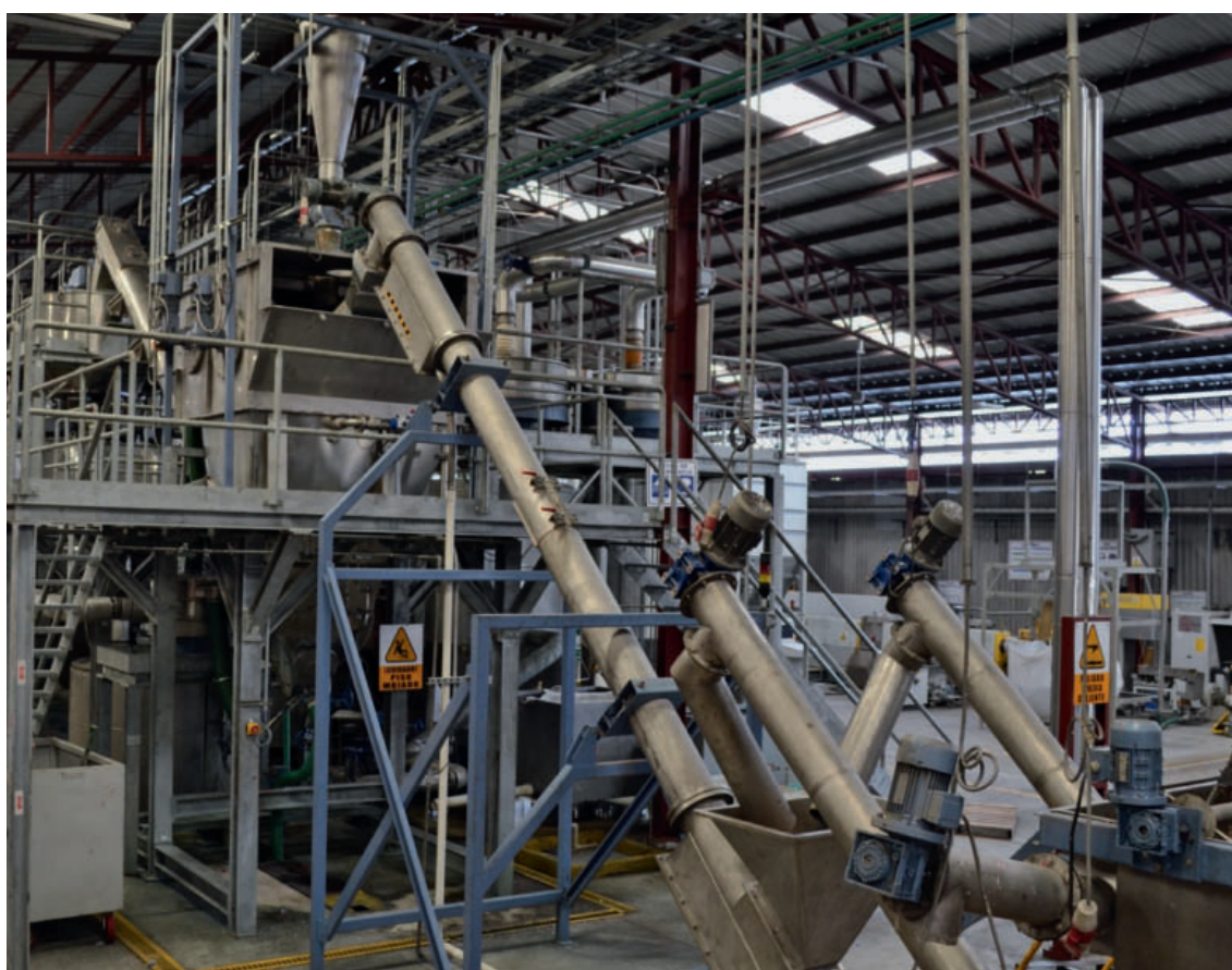
◀ Вторичная очистка полиолефиновой фракции на разделительной ступени гидроциклонной установки компании Herbold Meckesheim GmbH
