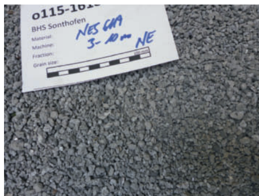
▲ Конечный продукт: фракция цветных металлов с размерами 3–10 миллиметров
