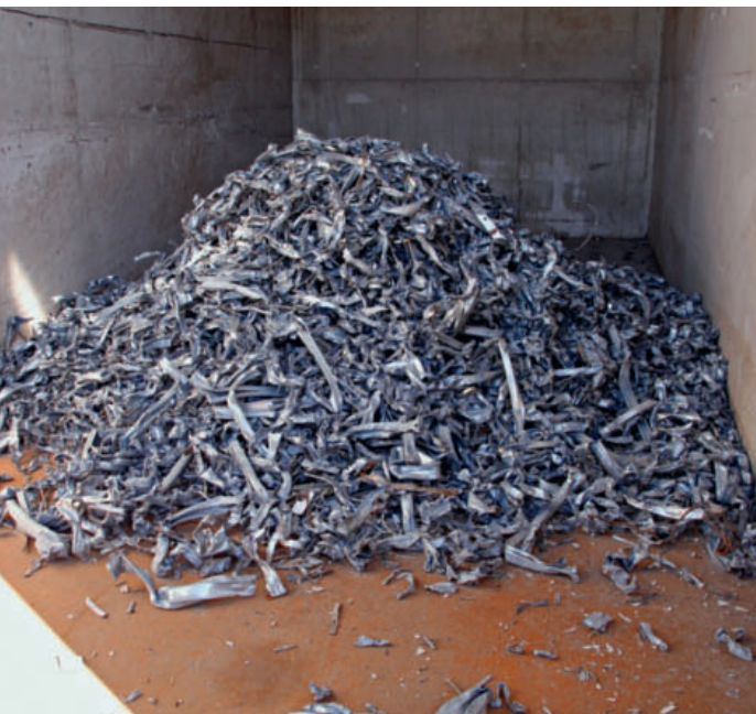
▲ Отходы черных металлов, выделенные после переработки окон
