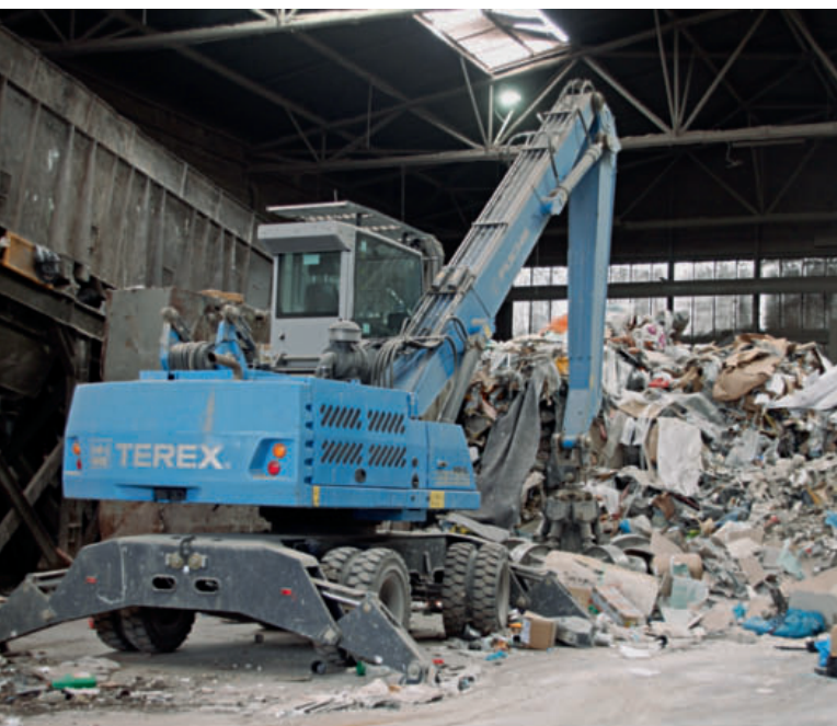
Кабина оператора поднимается на 1 метр и предоставляет ему хороший обзор для загрузки бункера установки для выработки вторичного топлива
