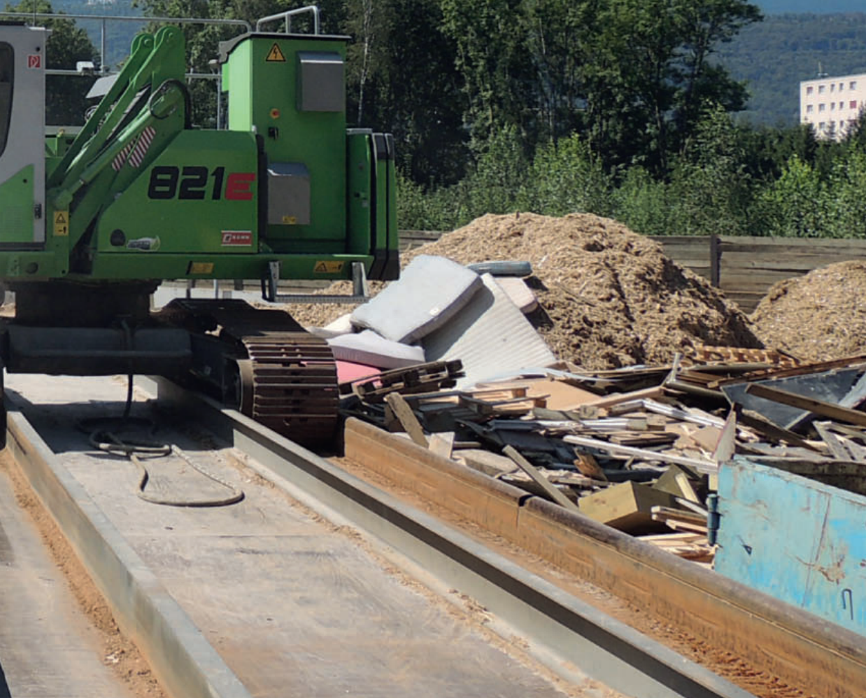
◀ Перегрузатель SENNEBOGEN 821 на гусеничном ходу на фирме Remo AG
