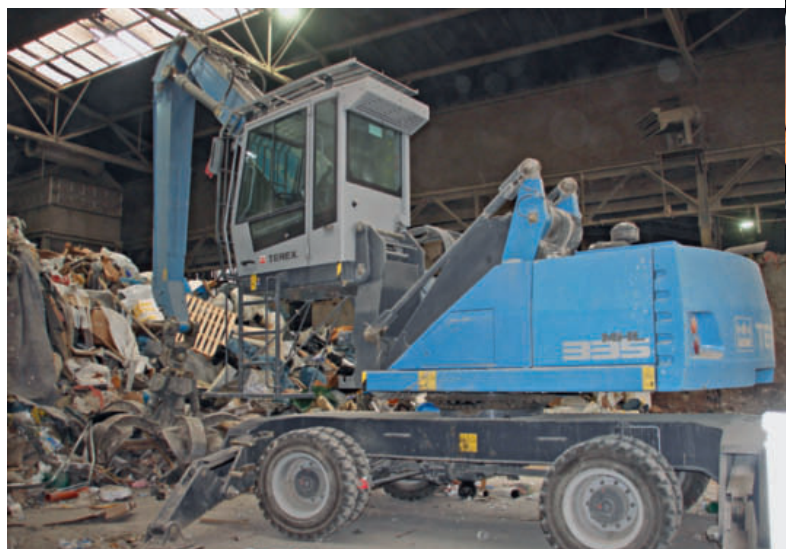
Кабина оператора поднимается на 1 метр и предоставляет ему хороший обзор для загрузки бункера установки для выработки вторичного топлива
