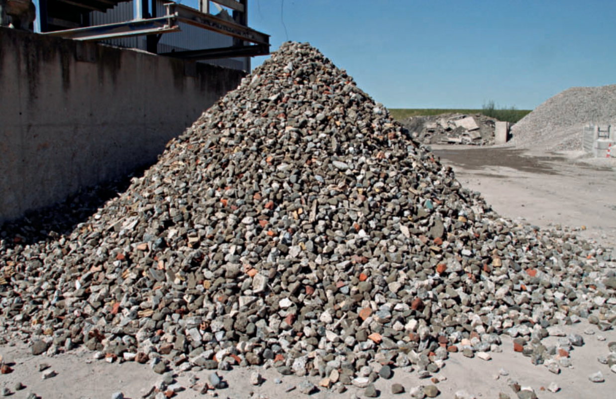
◀ Подготовленная фракция с размерами гранул 45/120 для улучшения основы дорожного покрытия и парковочных площадок Источник: Bauverlag BV GmbH
