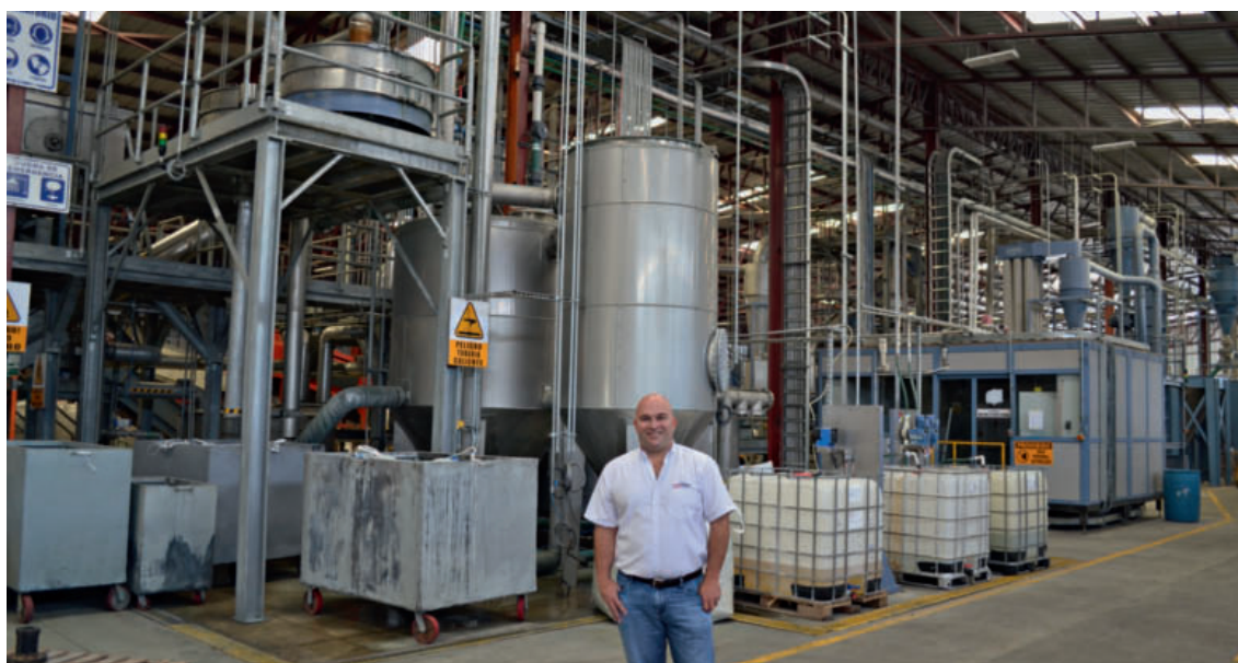
◀ Установка для горячей промывки хлопьев, полученных из пластиковых бутылок, компании Herbold Meckesheim обеспечивает высокое качество рециклата в производстве компании INVEMA
