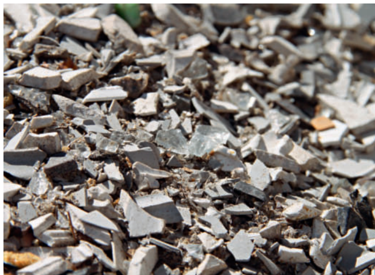
▼ Отсеянная мелкая фракция содержит минералы и стекло
