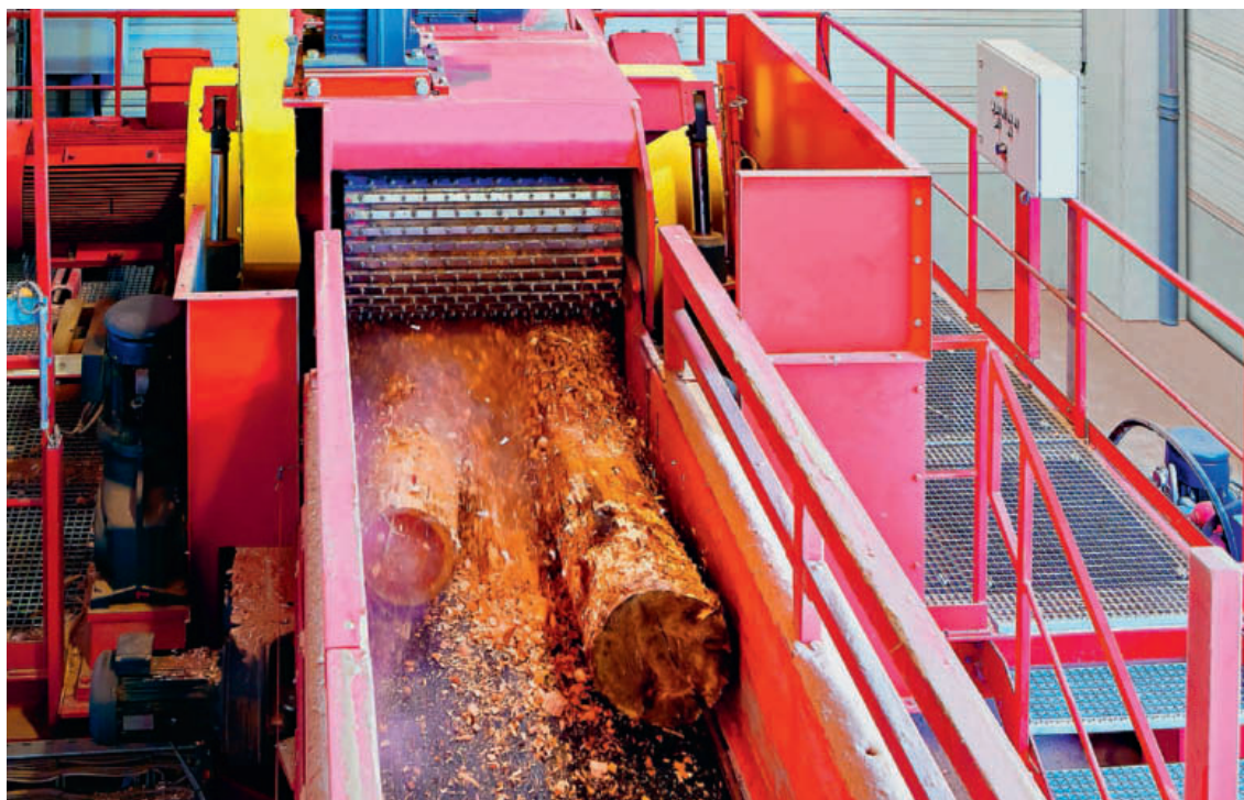
◀ Измельчитель биомассы VTH 105/60/4B – высокоэффективный, мощный комплекс Источник: Vecoplan AG
