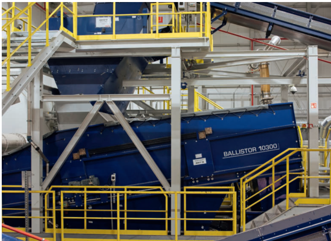
◀ Сепаратор Ballistor выделяет высокоэнергетическую фракцию из общего потока отходов Источник: Komptech
